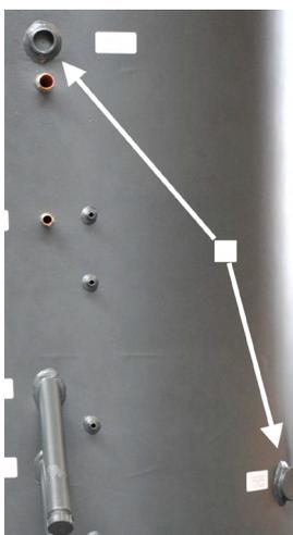
Die zwei Muffen für den E-Heizstab (1 1/2") bzw. den KV1-Anschluss (1") sind mit Kunststoffkappen verschlossen. Diese müssen bitte entfernt und entweder durch Anschlüsse oder Blindstopfen ersetzt werden.
