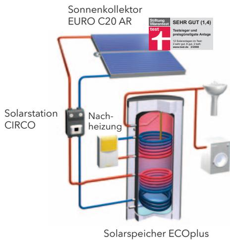
TOPline Solar-Warmwasserpaket BW 480plus AD
